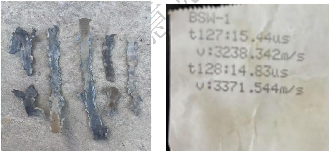
图2 药管爆破后的碎片及爆速结果
